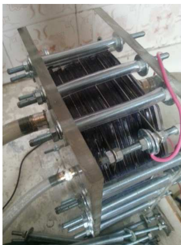
3 pav. „Sauso tipo“ sukonstruoto hho generatoriaus elektrodų bendras vaizdas
