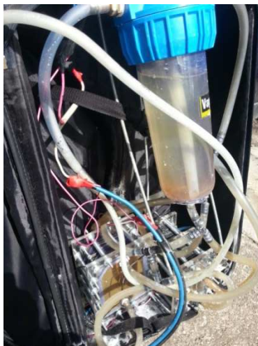
4 pav. Mobilaus elektrolizės generatoriaus bendras vaizdas *Šaltinis: sudaryta autoriaus
