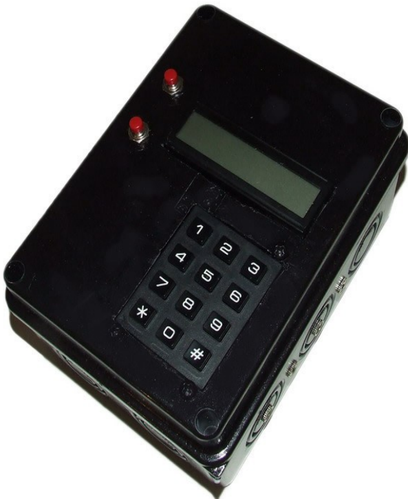
3 pav. Žmogaus fiziologiniams parametrų nuskaityti skirtą įrenginį „Atmega Oscilografas“ nuotrauka
